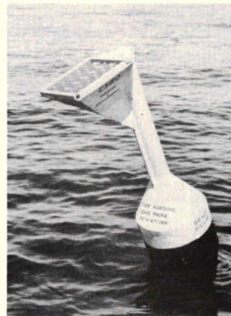
Afb. 2. Zonnecellen voor energievoorziening van bakens op zee.
